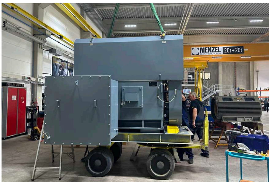
Bild: Menzel hat einen lagervorrätigen Käfigläufermotor für den Einsatz in Staub-Ex-Zone 22 und Umrichterbetrieb befähigt und für einen reibungslosen Austausch in der Kundenanlage ausgelegt
