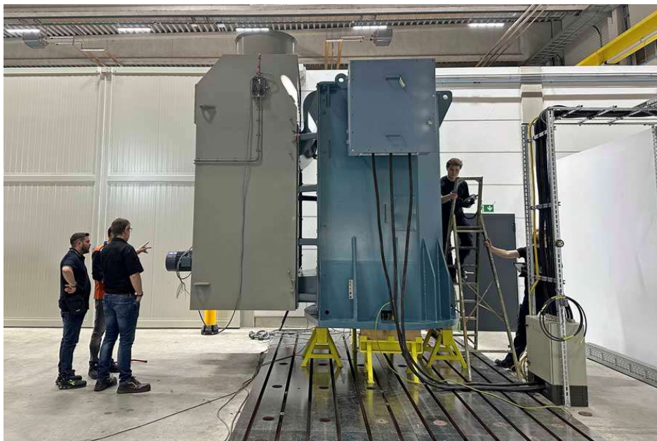
Bild: Mit der Konfiguration eines 20-t-Pumpenmotors hat Menzel Elektromotoren seinen bis dato größten Niederspannungsmotor gefertigt
