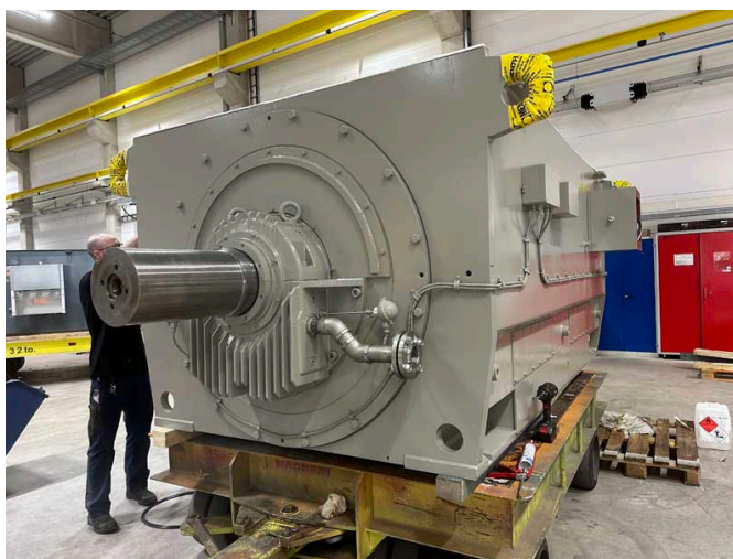
Bild: Der Mittelständler Menzel Elektromotoren stellte den explosionsgeschützten Kompressormotor in nur zwölf Kalendertagen fertig
