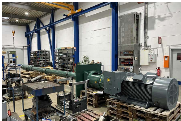
Bild: Menzel fertigte komplette Pumpensysteme mit Antrieb und Anschlussrohren aus einer Hand
