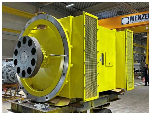
Bild: Basierend auf einem modularen Käfigläufermotor hat Menzel einen passgenauen Eins-zu-Eins-Ersatz für einen 50 Jahre alten Pumpenmotor in einem Heizkraftwerk gefertigt
