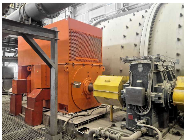
Bild: Alchemisches Geheimnis gelüftet: So wird aus Eisen und Kupfer Gold – mit Schwerlastmotoren, die im Doppelpack die Kugelmühle einer Goldgrube antreiben
