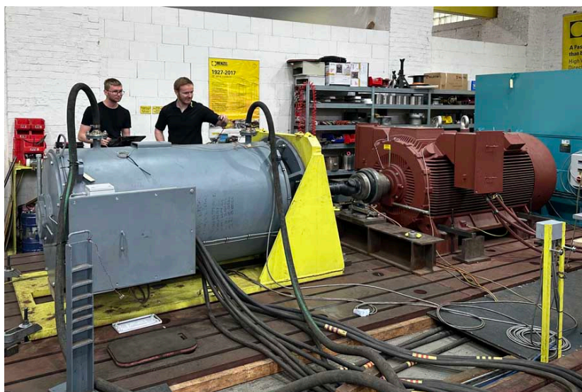
Bild: Menzel hat die Schiffsmotoren im eigenen Prüffeld gründlich getestet (hier: Käfigläufermotor mit Wassermantelkühlung)
